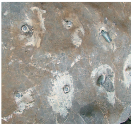
Zalepljena navojna palica trdote 4,6 se je v vseh poskusih odlomila.
