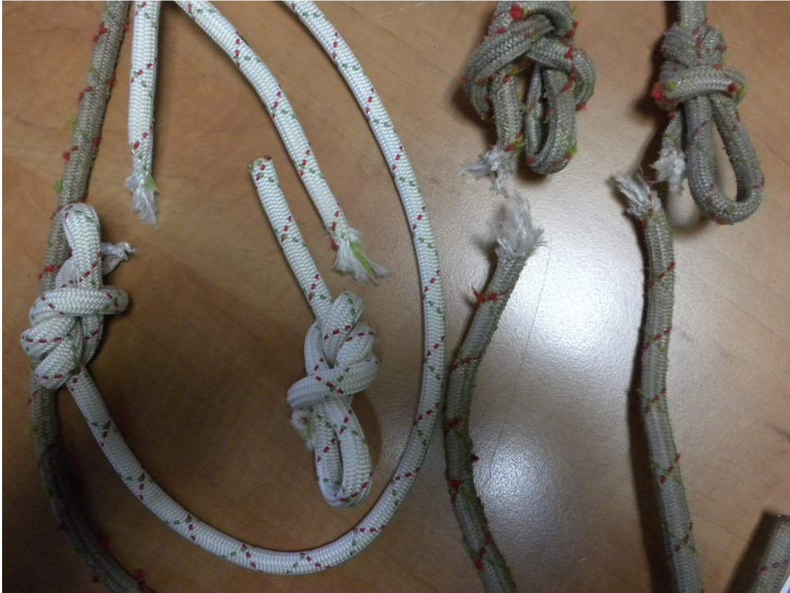
Slika 3: Vzorci po pretržnem testu.
