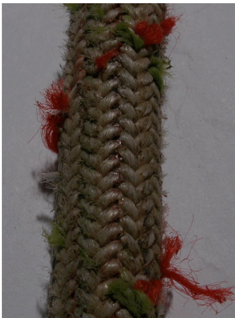
Slika 1: Močno poškodovana vlakna označbe.
