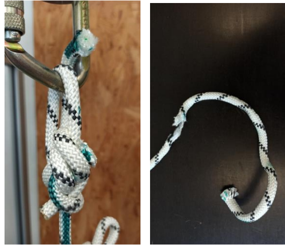
Slika 2: Šestica z dvojno zanko s prerezanim krakom zanke, ki izhaja proti delovnemu koncu vrvi.
