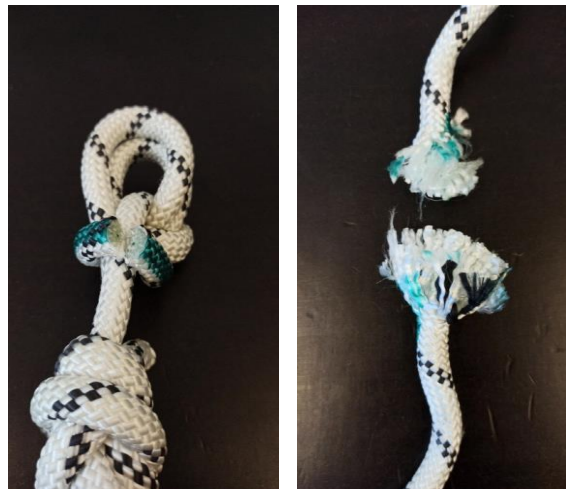
Slika 3: Šestica z dvojno zanko s skoraj povsem prerezanim zavojem, ki spaja oba kraka.
