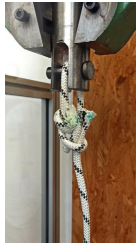
Slika 3: Šestica z dvojno zanko s skoraj povsem prerezanim zavojem, ki spaja oba kraka.
