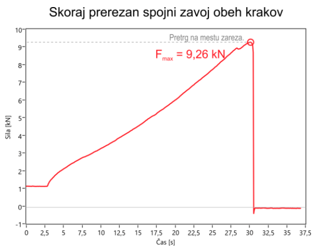
Slika 3: Šestica z dvojno zanko s skoraj povsem prerezanim zavojem, ki spaja oba kraka.
