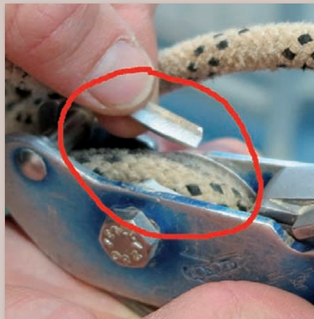
Slika 1: Posledice premočnega potega na odpisani zavori, blokirani z odpisano vrvo: skrivljen ročaj in počen ter zavrten zgornji kolot.
