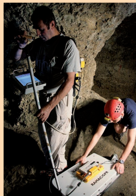
Pregled z georadarjem: iskanje skrivnega rova
