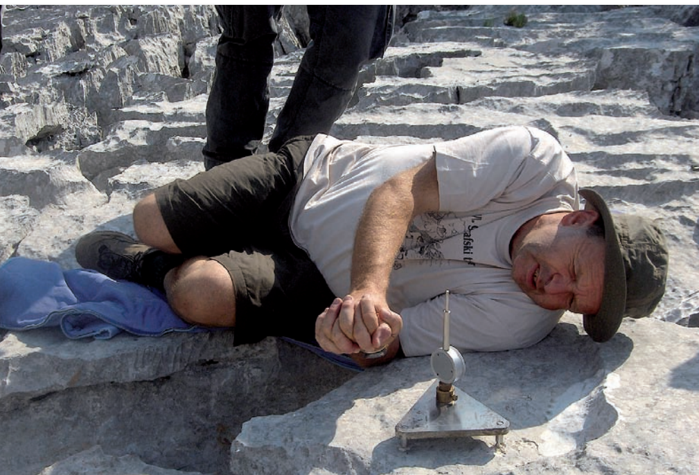
Orjen, leta 2009. Meritve korozije z mikrometrom.
